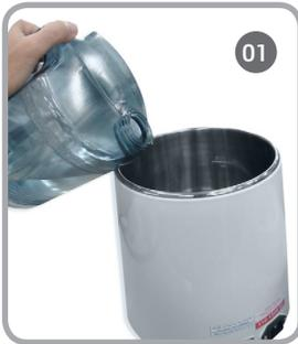
01. Remova a tampa de condensação, enxágüe a câmara de inox, depois complete a câmara com água de torneira até a marca máxima que é de aproximadamente 4 litros (não adicionar água acima desta marca);
